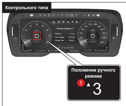
**▲ 3** Данный индикатор показывает наиболее подходящий момент переключения на 3-ю передачу (целевая) при управлении автомобилем на 1-й или 2-й передаче.
