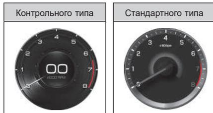
Указывает количество оборотов двигателя в минуту. Текущая частота двигателя получается при умножении указываемого значения на 1000.
