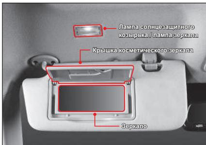
Лампа включается при опускании солнцезащитного козырька и открытии косметического зеркала.
