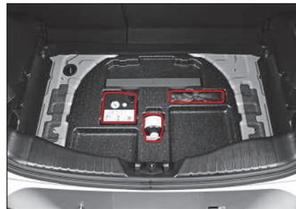
Возимый комплект инструментов хранится в ящике для хранения в задней левой части багажного отделения.
