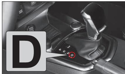
Данное положение рычага предназначено для движения по обычной дороге или автомагистрали.
