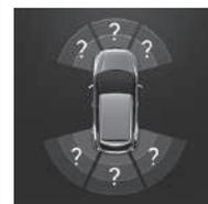
Если датчик обнаружения препятствий неисправен, для него отображается символ «?». Если на приборной панели отображается это сообщение, обратитесь за проверкой и обслуживанием автомобиля в ближайший авторизованный сервисный центр KGM.
