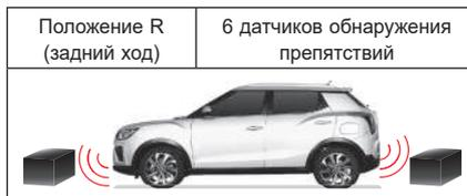
Когда рычаг переключения передач находится в положении R (задний ход), 2 передних датчика обнаружения препятствий и 4 задних датчика обнаружения препятствий активируются одновременно.
