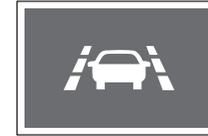
При активации системы предупреждения о сходе с полосы движения загорается индикатор на комбинации приборов.
