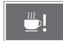
Эта сигнальная лампа загорается при неисправности блока, датчика и т. п., связанных с системой оповещения для привлечения внимания водителя .
