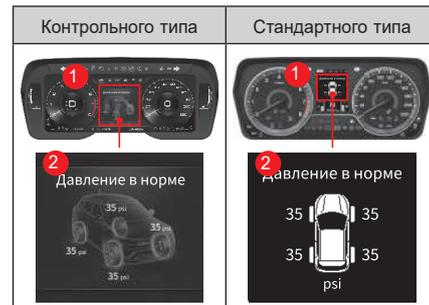
Выбрав состояние системы контроля давления в шинах в главном меню (1) приборной панели, на дисплее (2) приборной панели можно просмотреть давление во всех шинах.
