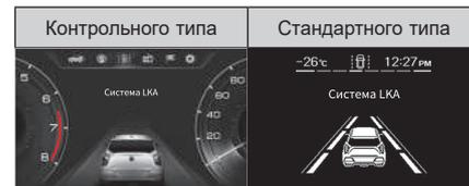
При обнаружении полос в соответствии с состоянием автомобиля, обнаруженная полоса отображается белым цветом, а также подается уведомление об обнаруженной полосе.
