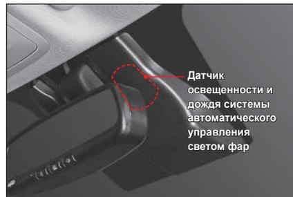
Датчик функции автоматического управления светом фар объединен с датчиком дождя.
