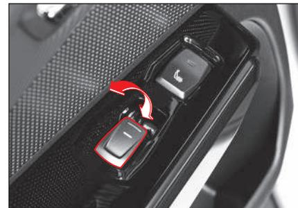
Окно работает, только пока нажата или поднята кнопка стеклоподъемника заднего окна.
