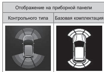
На приборной панели отображается расстояние до препятствия и звучит сигнал.
