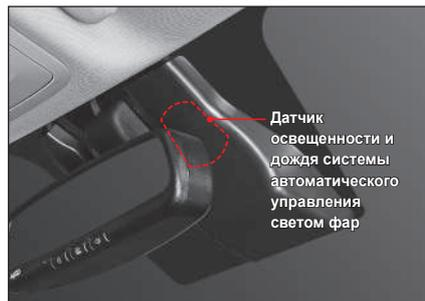
Датчик дождя объединен с датчиком системы автоматического управления светом фар.
