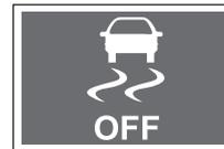
Данная контрольная лампа загорается при нажатии и удержании (в течение не менее 3 секунд) выключателя ESP.
