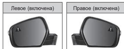
При обнаружении транспортного средства в задней или боковой зоне приближения загорается желтая сигнальная лампа на наружном зеркале заднего вида.
