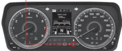
При штатном давлении в шинах или неисправности системы контроля давления в шинах сигнальная лампа TPMS мигает, а затем горит непрерывно.
