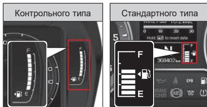
Указывает уровень оставшегося в баке топлива, когда кнопка запуска/останова двигателя находится в состоянии ON или во время работы двигателя.
