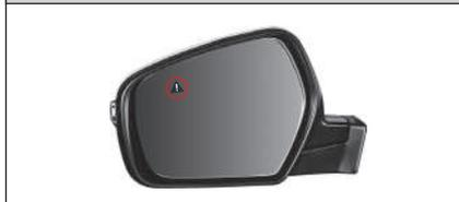
Если сигнальная лампа наружного зеркала заднего вида дважды мигает, когда кнопка запуска/останова двигателя находится в состоянии ON, или когда работает двигатель, это указывает на нормальную работу системы предупреждения о ситуации сзади и по бокам.
