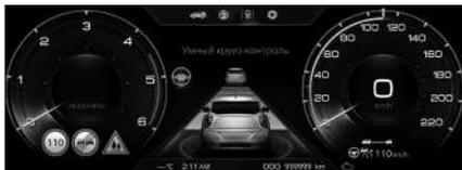
На основе информации, полученной от передней камеры (распознавание дорожных знаков) и данных навигации, на приборной панели отображается информация об ограничении скорости для полосы, по которой вы движетесь.
