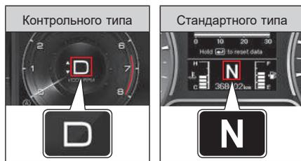
Текущее положение (P, R, N, D) рычага переключения передач и включенной передачи (1–6 ступень) в режиме M (ручной).
