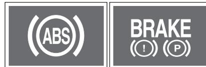
Если сигнальная лампа АБС и сигнальная лампа тормозной системы загораются одновременно, в системе EBD обнаружена неисправность. (Отдельной сигнальной лампы EBD нет).
