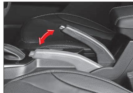
Поднимите рукоятку стояночного тормоза, чтобы проверить его работу.
