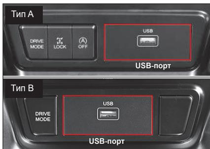
С помощью USB-порта можно подключить к автомобилю внешние устройства для воспроизведения музыки/видео, такие как USB-накопитель и iPod.
