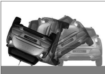
Если автомобиль переворачивается или опрокидывается, невозможно обеспечить полную защиту пассажира с помощью одной только подушки безопасности. В этом случае подушка безопасности может не сработать.
