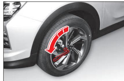
Слишком большое усилие, прикладываемое при затяжке, может привести к повреждению гаек. Не прикладывайте излишнее усилие к гайкам крепления колеса, наступая на ключ ногой или используя удлинитель ключа.
