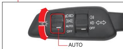
Автоматическое управление светом фар — определение датчиком освещенности и автоматическое включение или выключение фар и задних фонарей.
