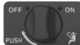
Подушка безопасности переднего пассажира отключена (не раскрывается) после установки данного выключателя в положение «OFF». Выключатель расположен на приборной панели справа, и его видно при открывании пассажирской двери. Нажмите и поверните выключатель в требуемое положение.
