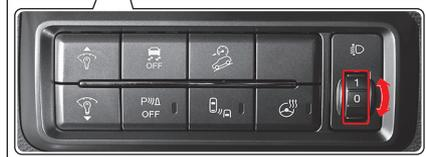
Наклон автомобиля вперед и назад может варьироваться в зависимости от числа пассажиров, массы и центра тяжести багажа.
