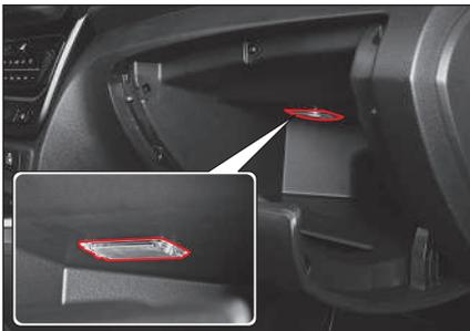
Лампа включается при открытии перчаточного ящика и выключается при его закрытии.
