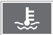
О перегреве двигателя может свидетельствовать включение сигнальной лампы перегрева двигателя и выходящий из моторного отсека пар.
