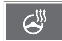
Если нажать кнопку обогрева рулевого колеса, когда кнопка запуска/останова двигателя находится в состоянии ON или при работающем двигателе, контрольная лампа обогрева рулевого колеса загорается или гаснет.
