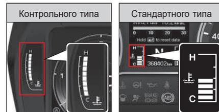
Температура охлаждающей жидкости двигателя.
