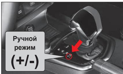
При перемещении рычага переключения передач из положения D (движение вперед) в положение +/- (ручной режим) водитель может вручную переключать передачи (с 1-й по 6-ю) аналогично механической коробке передач.
