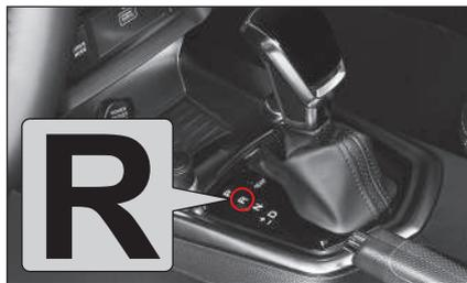
Данное положение рычага используется для движения задним ходом.
