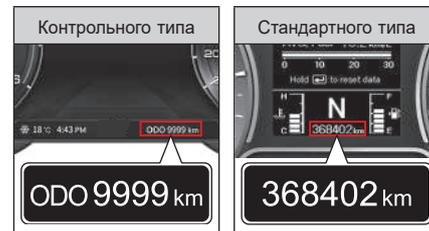
Общий пробег автомобиля в километрах.
