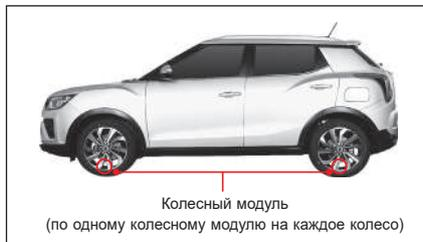
Электронный блок управления системы контроля давления в шинах принимает различные данные, включая сведения о давлении и температуре в шинах, с установленного на каждом колесе колесного модуля, и выводит эти данные на дисплее приборной панели.
