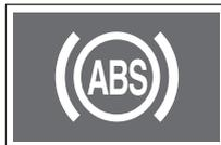
Сигнальная лампа загорается, если кнопка запуска/останова двигателя находится в состоянии ON, и гаснет, если система работает нормально.
