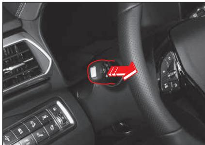
Дальний и ближний свет включаются одновременно, если нажать на комбинированный переключатель света в сторону водителя.
