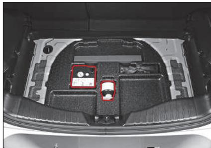
Ремонтный комплект для шин хранится в ящике для хранения в задней левой части багажного отделения вместе с возимым комплектом инструментов.
