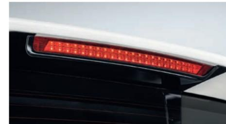
Светодиодный дополнительный стоп-сигнал
